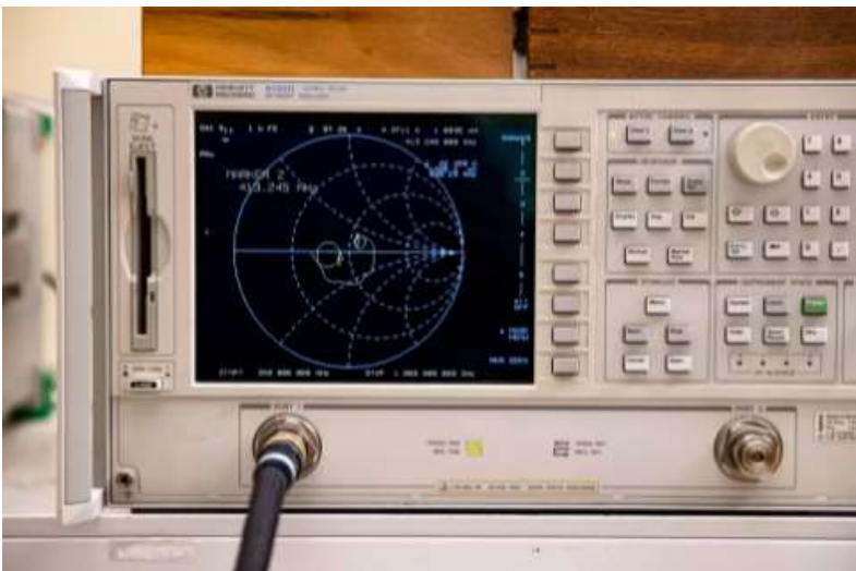
Piirianalysaattorilla mitataan elektroniikkapiiriin tai antennin kytkentäpisteen sähköisiä ominaisuuksia ja sitä, miten hyvin signaali etenee kytkentäpisteestä piiriin tai tässä tapauksessa antenniin. Kuvassa tuloksia visualisoidaan Smithin kartalla. KUVA: ERIIKA AHOPELTO / AAMULEHTI
